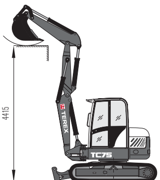
Obr. 2: Otočný výložník - překládací výška
